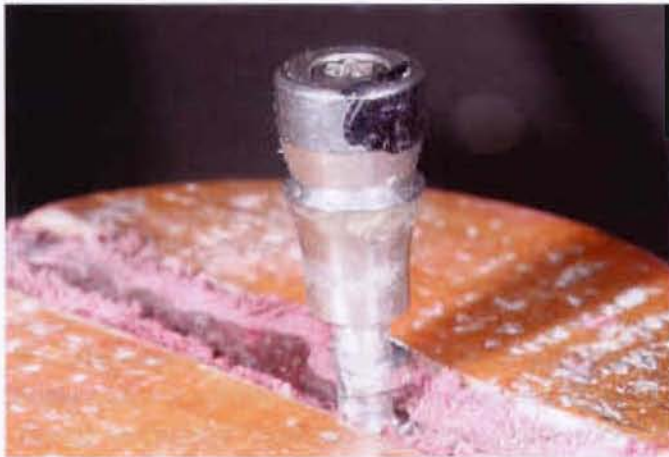
Abb. 3 Ein Klemmholz mit Lederbesatz aus der Goldschmiede und ein altes Laborimplantat als Hilfsmittel.
