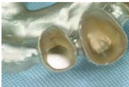
Abb. 3 In der Krone befand sich eine dicke Luftblase, so dass nun auch der Stumpf zu gut einem Drittel mitgegossen wurde.
