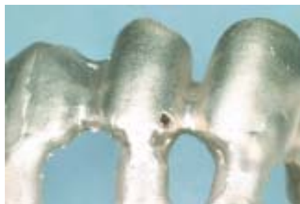
Abb. 2 Ein Lunker in einer 10-gliedrigen Brücke
