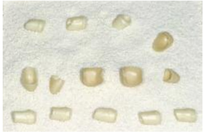
Abb. 24 Nach der Sinterung sind die Teile bereits durchgefärbt
