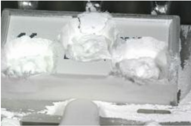
Abb. 23 Nach einem festgelegten System werden die Teile aus dem Rohling herausgefräst
