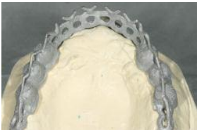
Abb. 34 Im Abhebeverfahren mittels Einstückguss hergestelltes Metallgerüst (Dreibettmasse)
