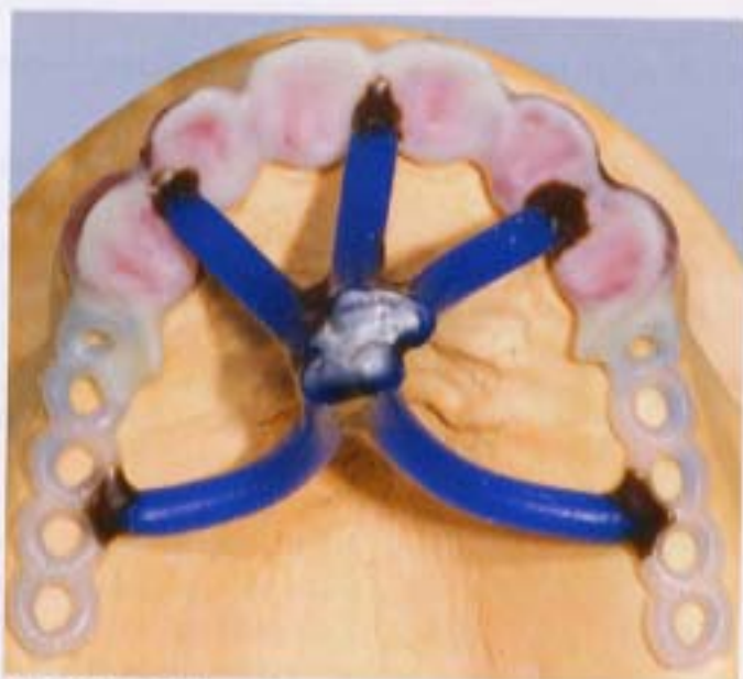
Abb. 25 Das Gusskanalsystem muss für die verwendete Legierung geeignet sein und darf auf keinen Fall Spannungen erzeugen.
