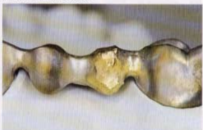
Abb. 10 und 11 Man sollte nicht mehr Lot auftragen, als für den Lötspalt und die Benetzung der Grenzflächen benötigt wird. Die Abbildungen zeigen uns die korrekt durchgeführte Lötung.
