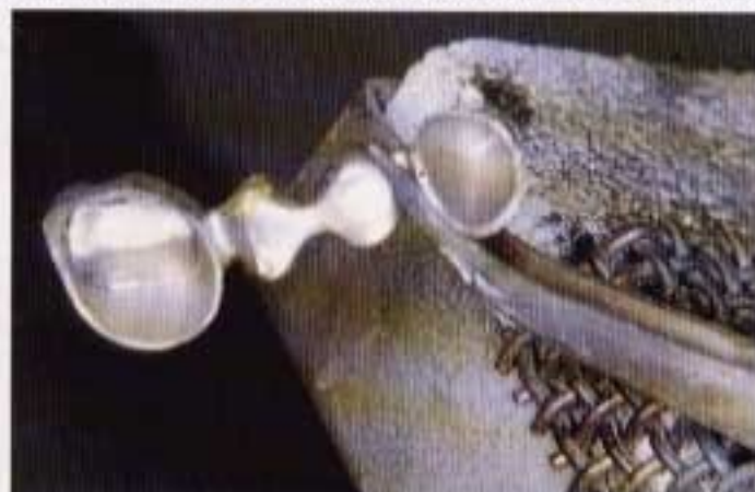
Abb. 9 Wir legen wir Lot nach, lassen es beim Drehen des Objekts erstarren und setzen die Lötung dann von der anderen Seite fort
