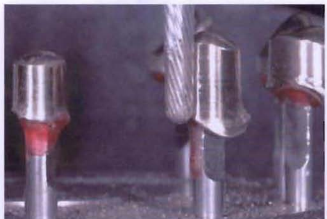
Abb. 2 Die Oberflächenzähigkeit der Legierung setzt scharfe Fräsen voraus.
