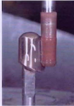
Abb. 4 Etwas Fräsöl schadet nicht, mit sehr niedriger Drehzahl wird vorpoliert.
