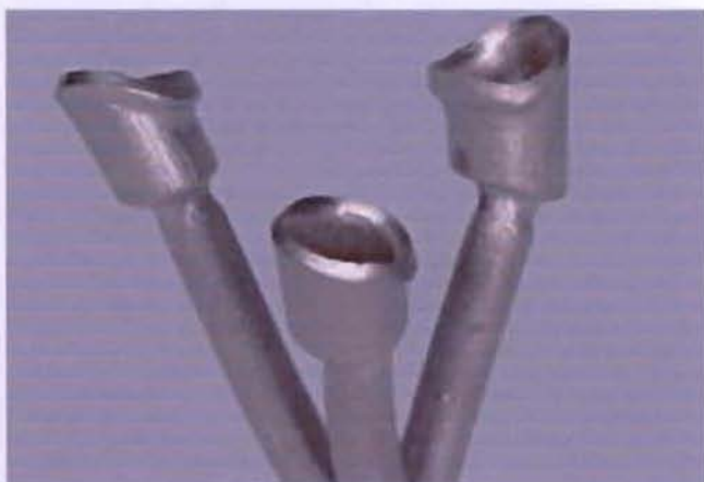
Abb. 1 Ein sauberer und homogener Guss aus der neuen Legierung Orplid TKS.
