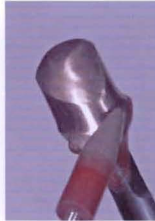
Abb. 5 Ohne Druck werden die schrägen Flächen von Hand aufbereitet.
